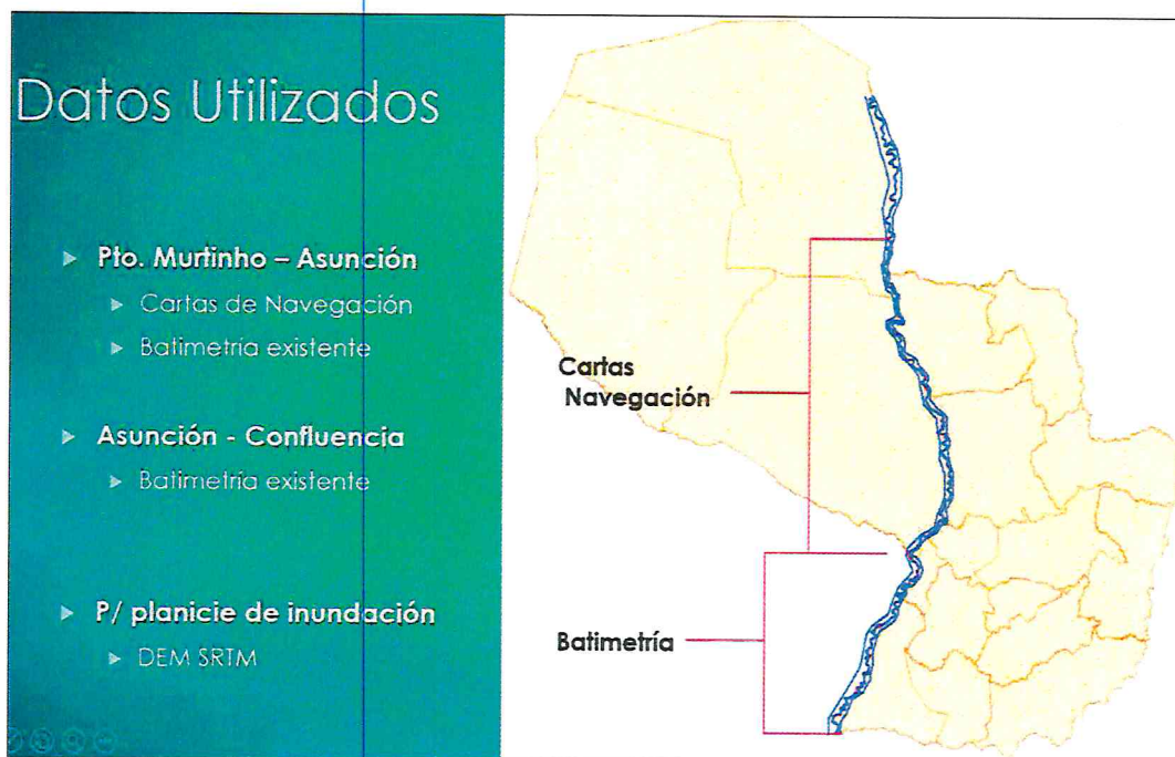
Fig. 3.9: Datos topográficos de superficie y batimétricos utilizados
