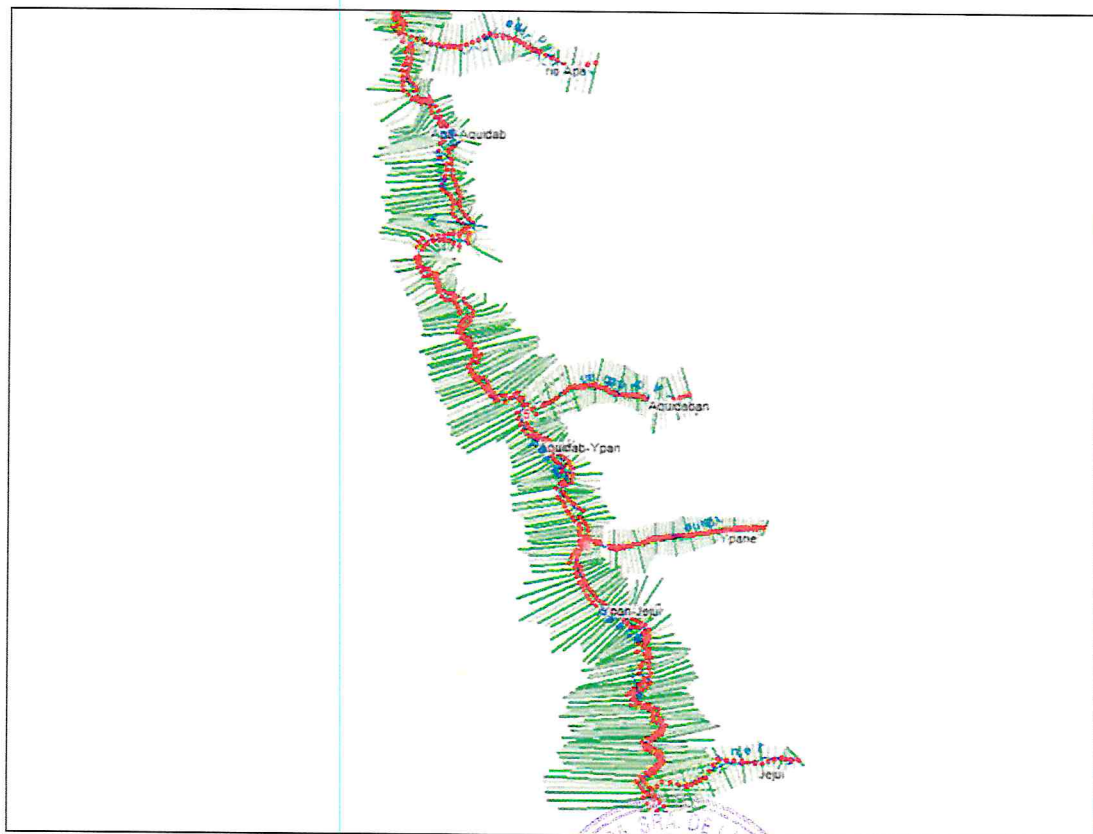
Fig. 3.15: Secciones transversales al cauce rio Paraguay –Modelo Hec Ras
