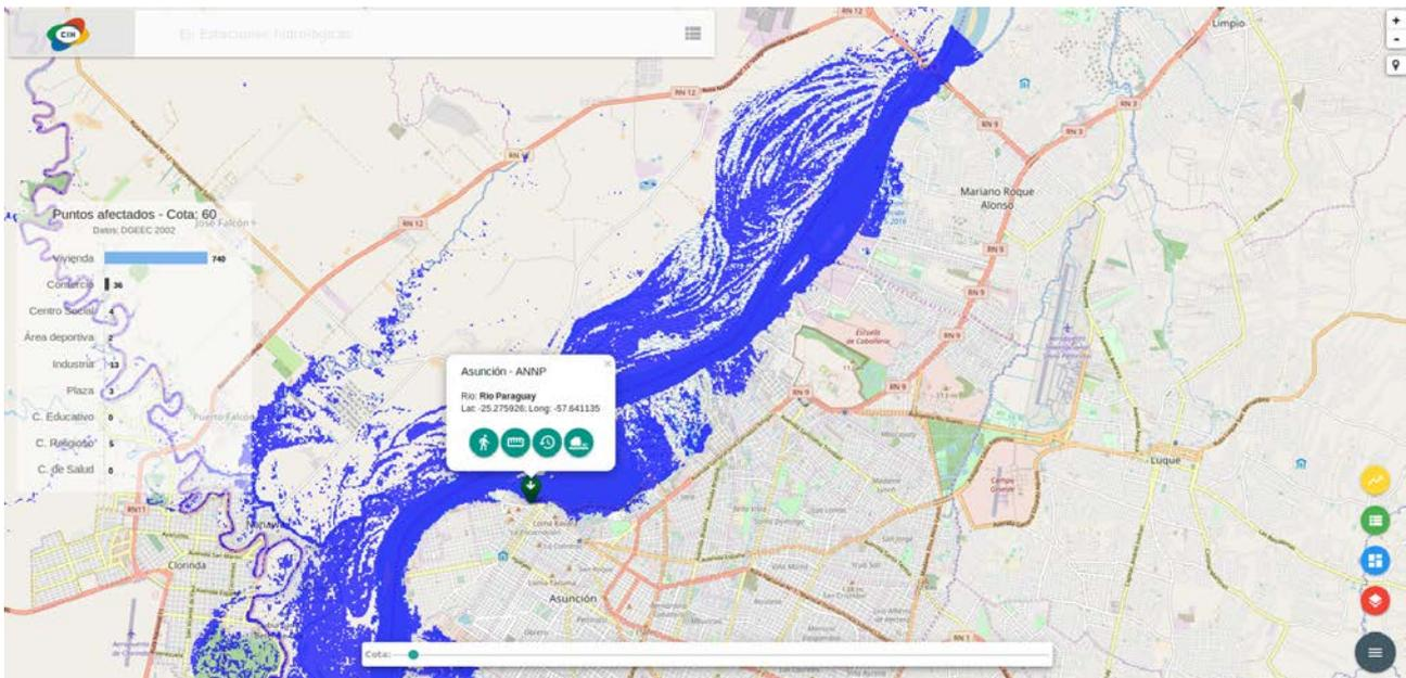
Figura 4. Control de cota para estimación de área inundada y contabilización de afectados.
